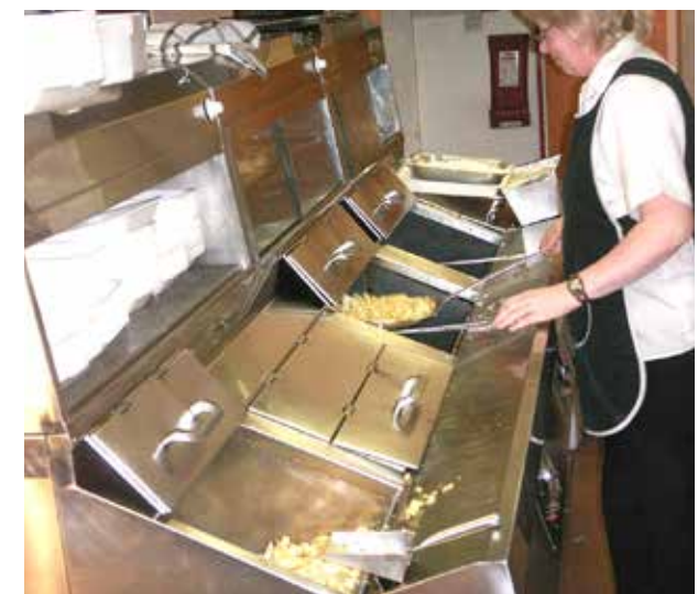
店舗がワンフロアで完結しているフィッシュ・アンド・チップス店によく見かける、専用フライヤー。魚用、チップス用、それ以外と揚げのセクションが分かれている。© Rathfelder
