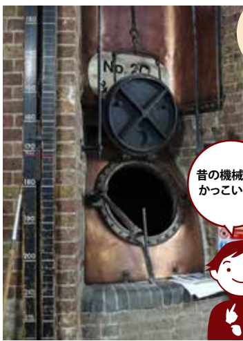
▲ ヴィクトリア朝時代の1823年から1984年まで使われた、ホップを入れて煮沸するためのタンク。所内で最も古いタンクなのだそう。 ▶ 1863年に導入され1993年に『引退』したマッシュ・タン（詳しくは4にて）。
